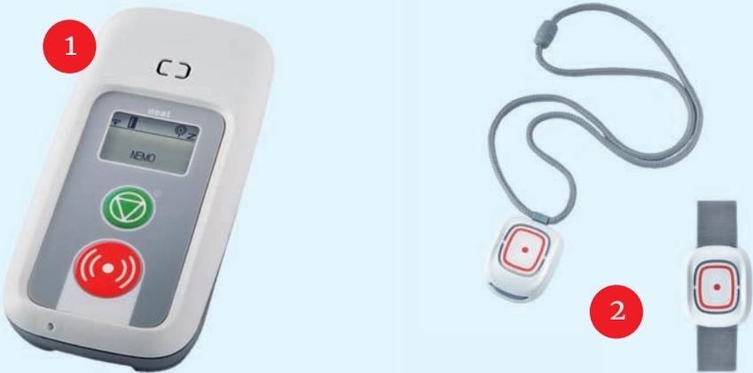
Das **Mobilrufgerät 1** passt in jede Jacken- oder Hosentasche und verbindet Sie im Notfall per Knopfdruck auf die Notfalltaste direkt mit der DRK-Notrufzentrale – rund um die Uhr, 365 Tage im Jahr. Dank integrierter GPS-Funktion lässt sich unterwegs im Notfall über Satelliten Ihr Standort bestimmen. Und zu Hause wird Ihr Mobilrufgerät in Kombination mit dem **Handsender 2** zum mobilen Hausnotrufsystem.
