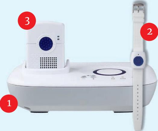
Sicherheit für zu Hause und unterwegs: Mit dem Kombi-Notrufgerät können Sie per Notruftaste auf der **Basisstation** ① oder am **Armband** ② (auch verfügbar als Halskette) in Ihren eigenen vier Wänden einen Notruf auslösen. Zusätzlich kann mit dem **mobilen GPS-Ortungsgesät** ③ über eine SOS-Taste auch unterwegs ein Notruf ausgelöst werden. So sind Sie ortsunabhängig und rund um die Uhr nur einen Knopfdruck von Hilfe entfernt.
